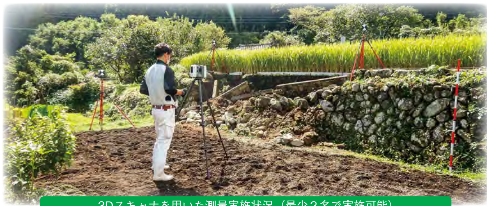
3Dスキャナを用いた測量実施状況（最少2名で実施可能）
