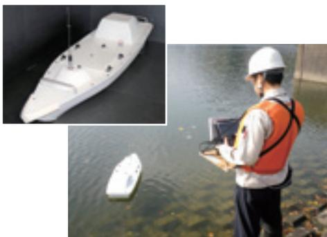
GPS・ソナーが搭載された小型自立走行型の深浅測量用のラジコンボートです。
