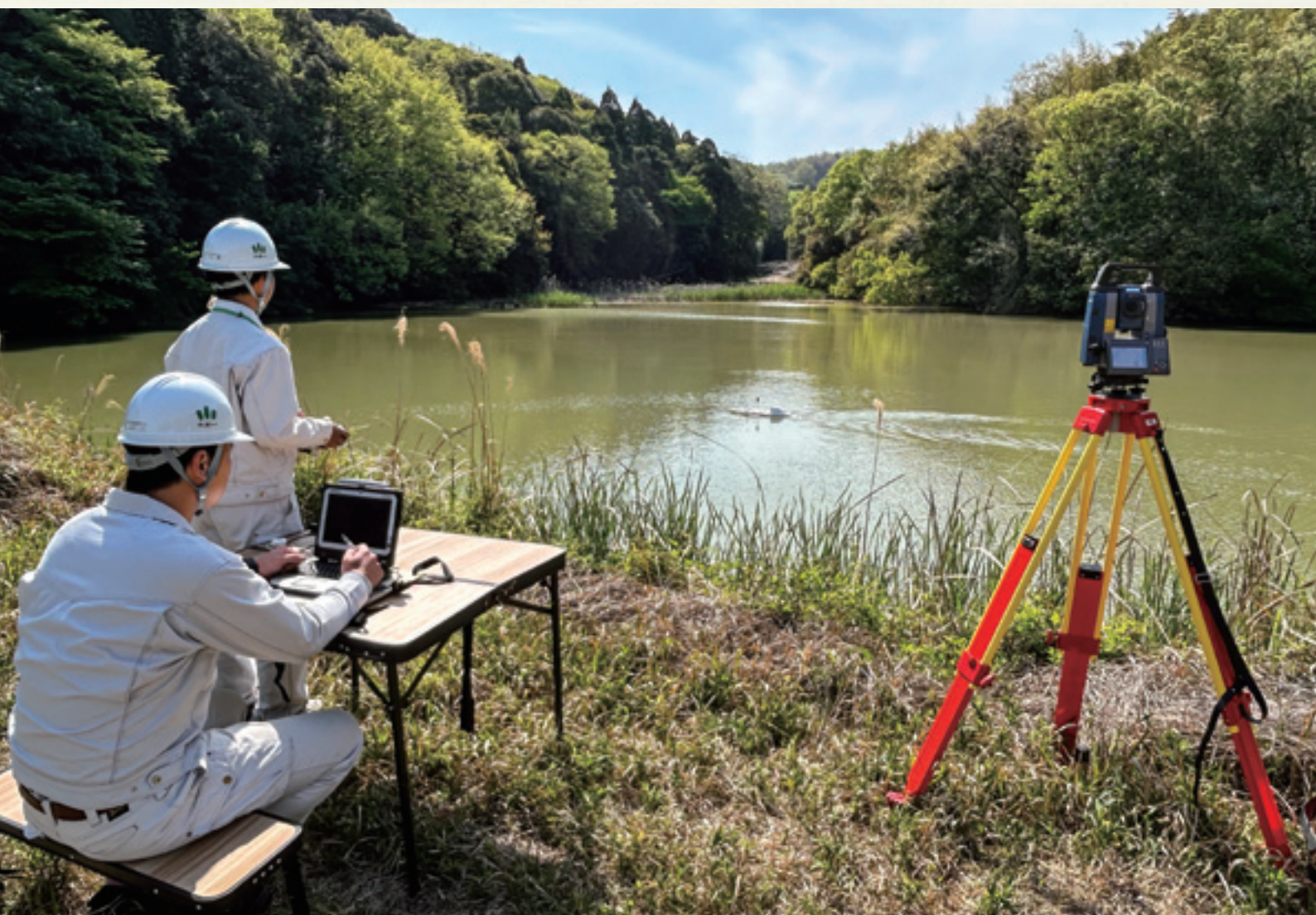
水上ドローンを用いた溜池の深淺測量（大分市）
