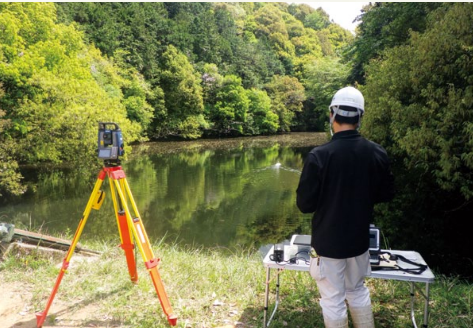
深浅測量（水上ラジコンボート）調査の様子
