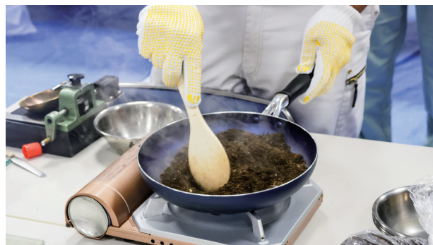
室内実習試験の様子 土の含水比試験
